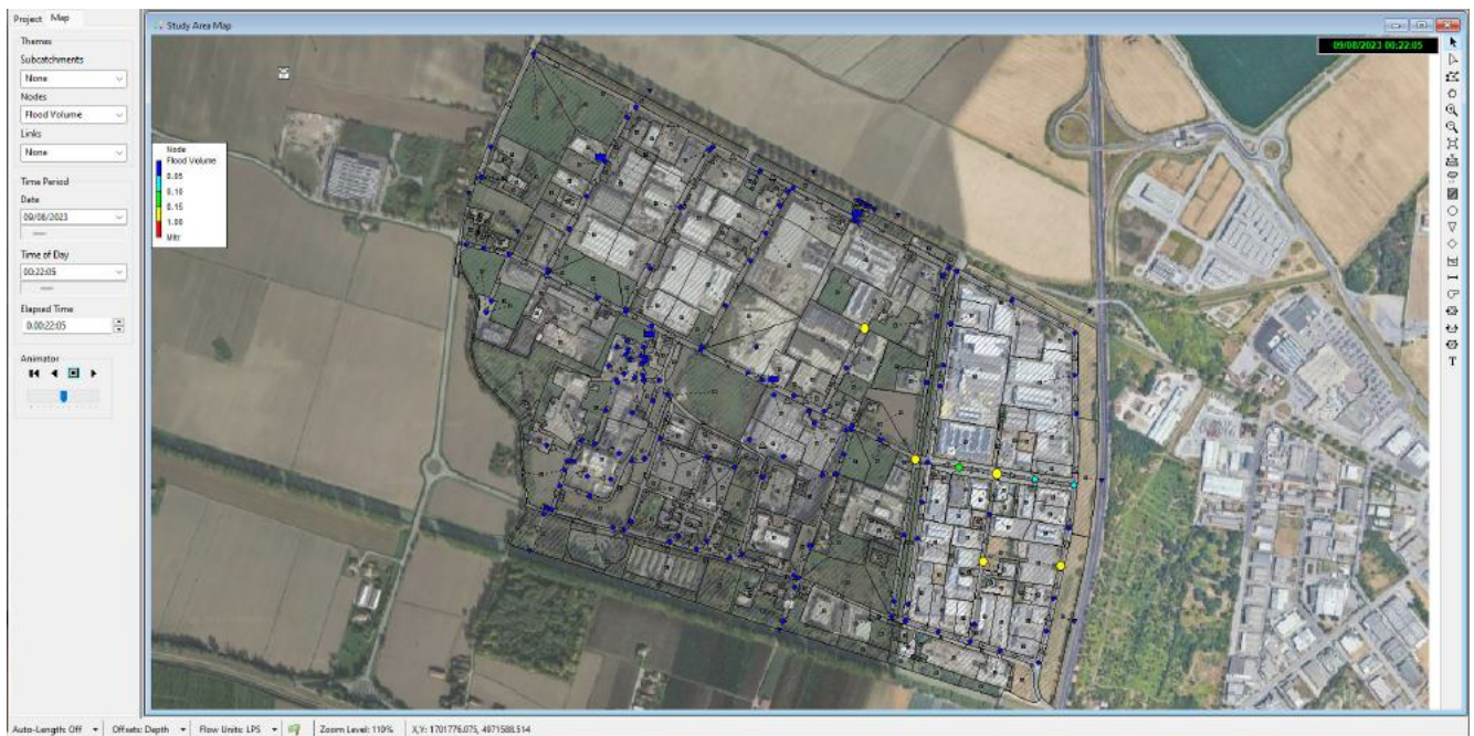
Fig. 49 – Nodi idraulici nei quali si potrebbe verificare il fenomeno del “flooding”
