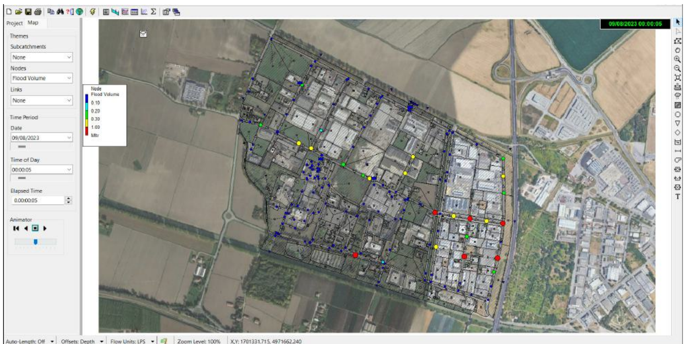
Fig. 75 – Nodi idraulici nei quali si potrebbe verificare il fenomeno del “flooding”
