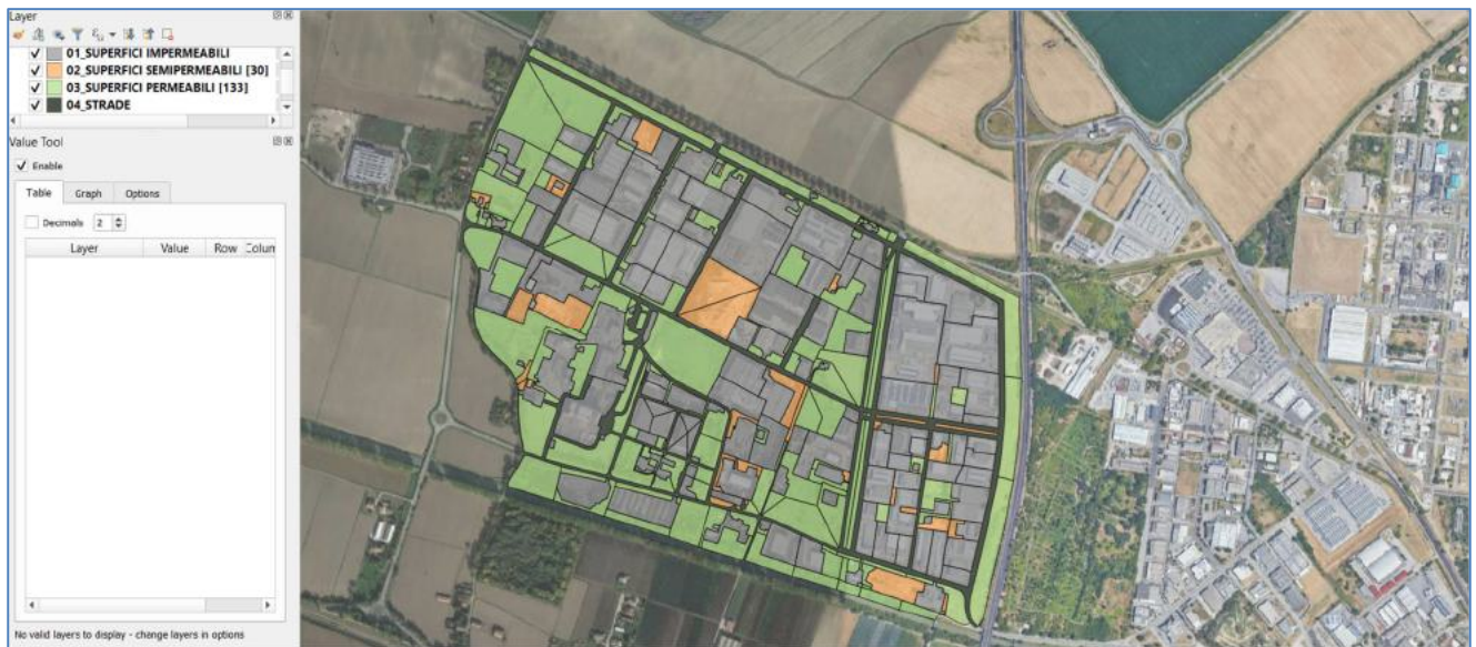
Fig. 82 – Suddivisione delle aree scolanti in impermeabili-semiimpermeabili-permeabili
