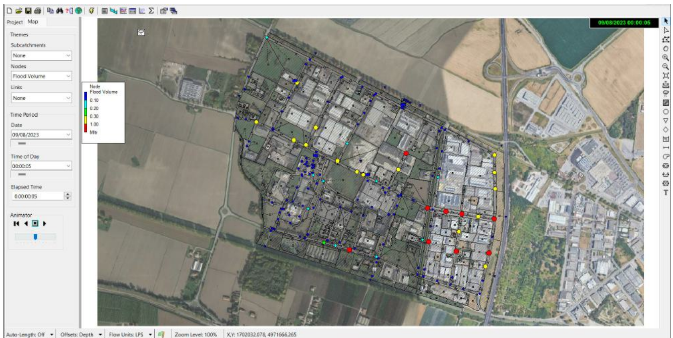
Fig. 70 – Nodi idraulici nei quali si potrebbe verificare il fenomeno del “flooding”
