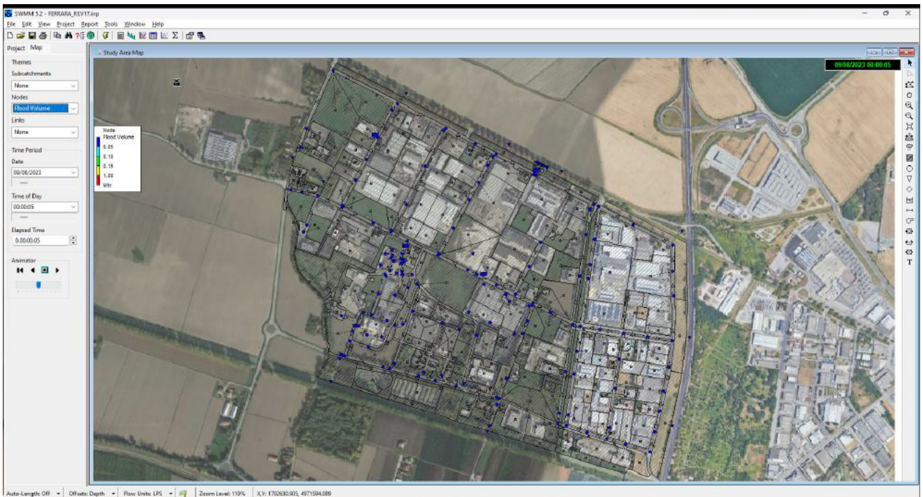
Fig. 43 – Nodi idraulici nei quali si potrebbe verificare il fenomeno del “flooding”
