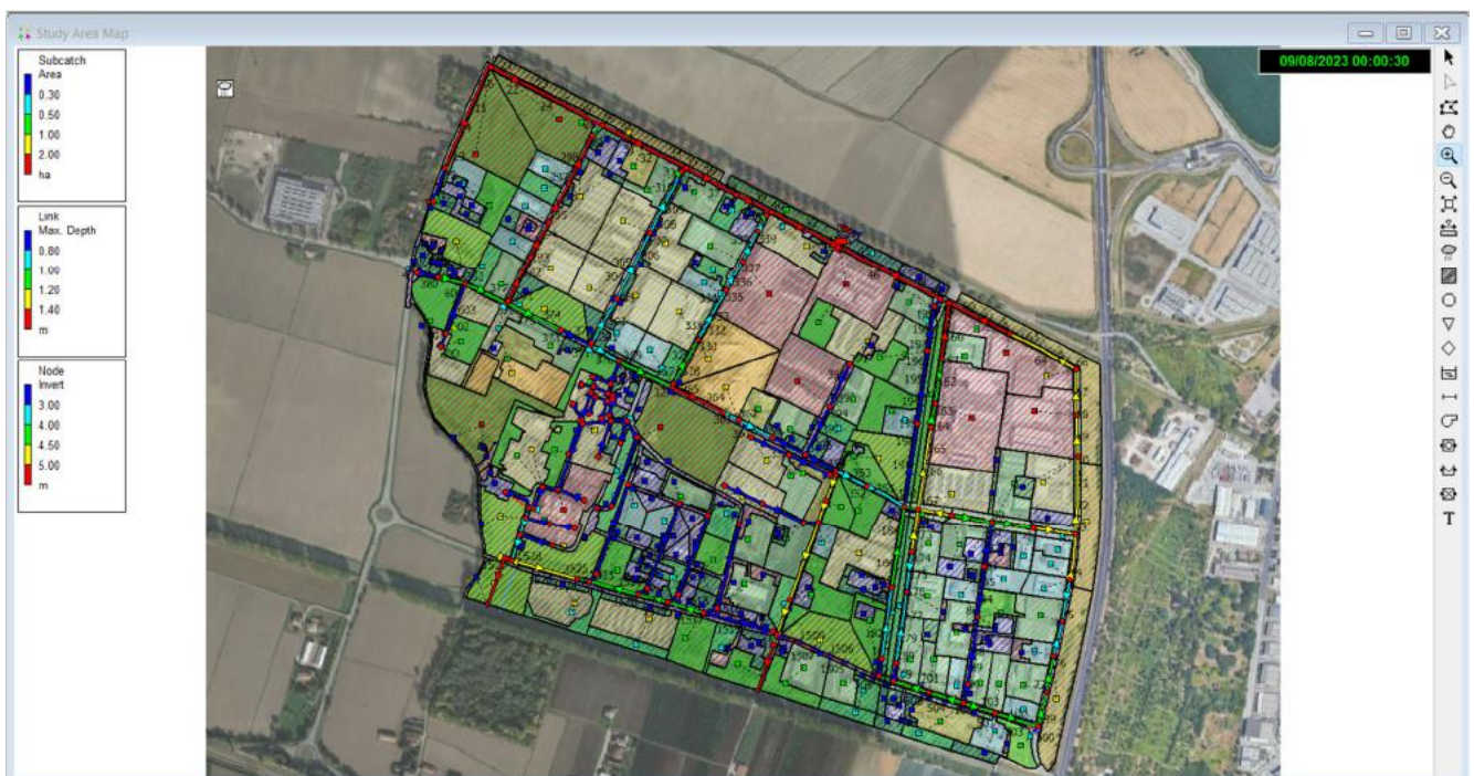
Fig. 20 – Implementazione della rete fognaria esistente e relative aree scolanti (EPASWMM5)
