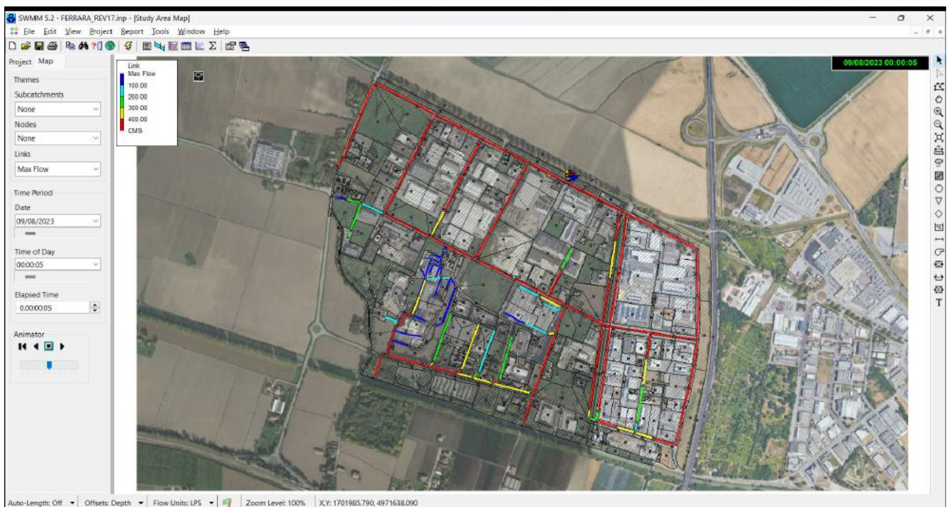
Fig. 66 – Rete fognaria – Portate massime nei singoli rami (l/s)
