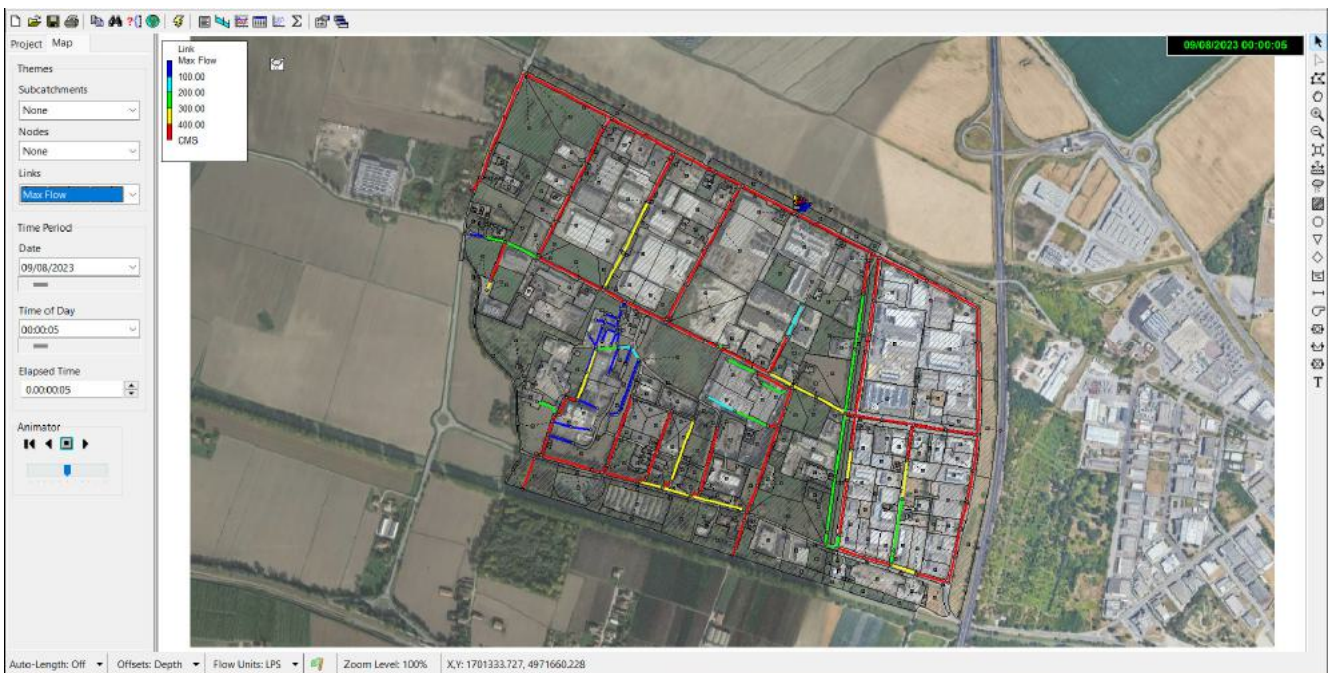
Fig. 71 – Rete fognaria – Portate massime nei singoli rami (l/s)
