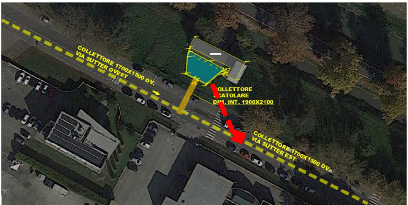
Fig. 90 – Estratto della planimetria dell'impianto di sollevamento e del nuovo collegamento con il collettore di via Sutter (est)
