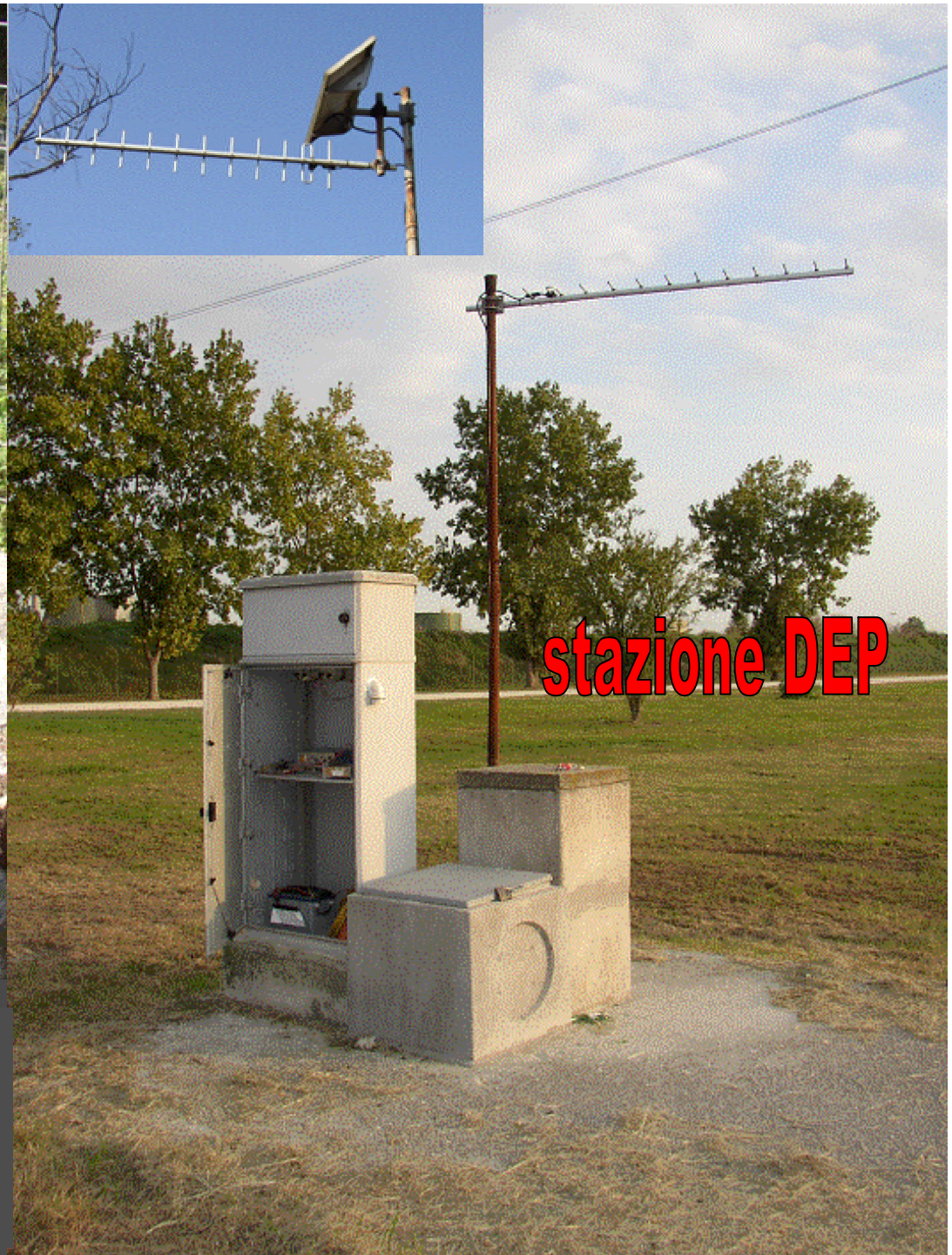
Stazione di monitoraggio (DEP) Rete microsismica Comune di Ferrara (sistema di trasmissione dati)
