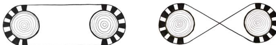
Immagine 16: Modalità suggerite di installazione del sistema a cavo e distanziatori
